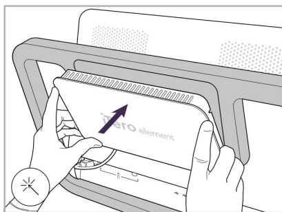
15. Fest det magnetiske bakdekselet.
